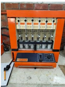
Ilustración 14 Proceso de extracción de grasa
