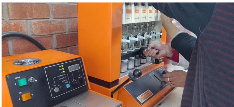
Ilustración 12. Proceso de extracción de grasa
