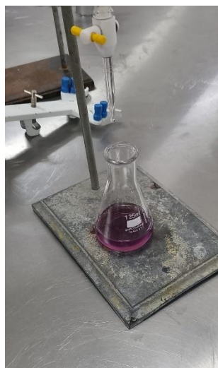
Ilustración 10. Titulación de la muestra para determinación de proteína
