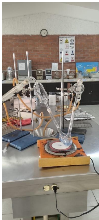
Ilustración 11. Destilación de la muestra para determinación de proteínas
